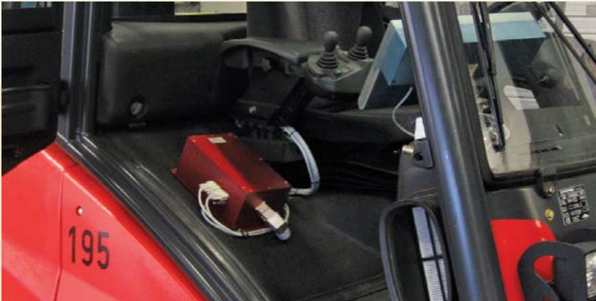
Abb. 14: RFID-Lesegerät in einer "Red Box" an Bord eines Gabelstaplers, Foto: [8]
