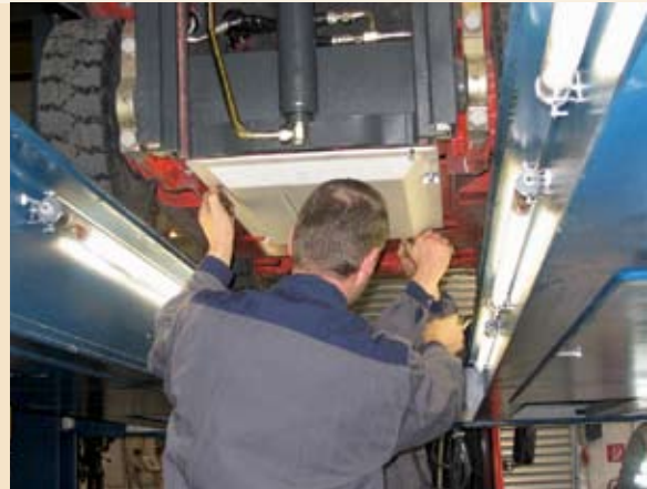
Abb. 13: RFID-Antenne unter dem Boden eines Gabelstaplers, Foto: [8]
