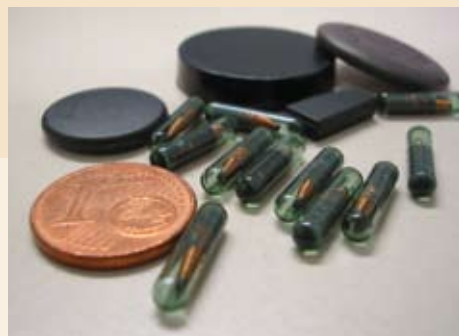
Abb. 8: Transponder in Form von Glasröhrchen und Scheiben, Foto:[6]
