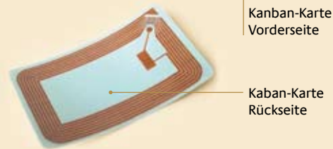
RFID-Kanban-Karte mit integriertem RFID-Transponder
