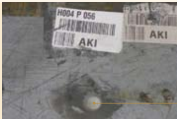
RFID-Transponder im Boden eingelassen
