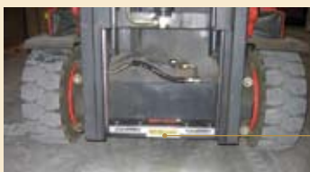
RFID-Antenne am Gabelstapler montiert
