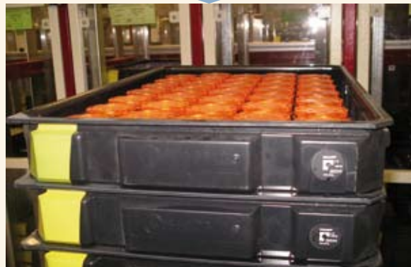
Gefülltes Tray mit Kunststoffkalotten (Identifikation über Transponder)
